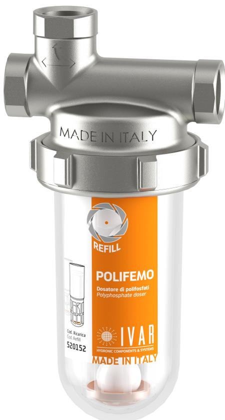
POLIFEMO® e POLIFEMO® PLUS sono dispositivi senza organi in movimento che tramite il consumo calibrato delle sfere contenute nella cartuccia, effettuano un dosaggio proporzionale di polifosfati e silicati alimentari nell'acqua fredda sanitaria.
