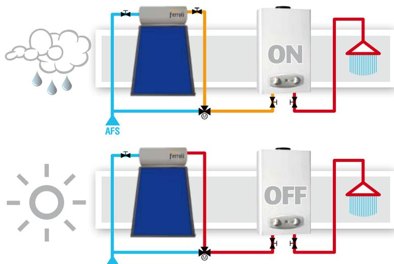
In caso di irraggiamento insufficiente e quindi un pre-riscaldamento modesto dell'acqua sanitaria, lo scaldacqua contribuirà con il calore necessario per raggiungere la temperatura di setpoint richiesta.
