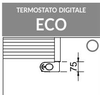
L'ingombro complessivo del radiatore in altezza va calcolato considerando l'altezza del termostato.
