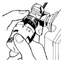
Prima di procedere all'installazione del kit termostatico, portare il selettore della testa in posizione "5", in modo da facilitare le successive operazioni di installazione.
