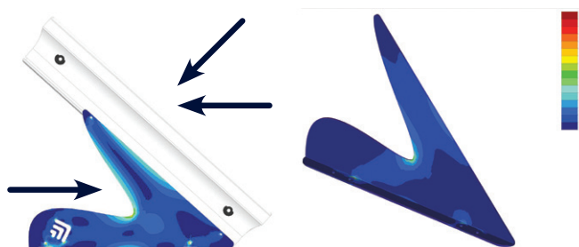
SIMULAZIONE CON ANALISI FEM DEL CARICO DEL VENTO E DELLA NEVE
